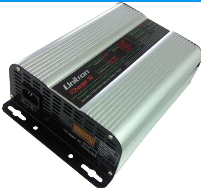
O Carregador Unitron iCharger 30 trabalha em tensões de entrada de 100 a 240 Vca, 50 a 60Hz, e detecta automaticamente a tensão da bateria, 12 ou 24 V. Apresenta alta eficiência, da ordem de 85%, e fornece 30 A em 12V ou 15 A em 24 V. Dispõe de proteções contra inversão de polaridade, sobrecarga, curto-circuito e superaquecimento.
