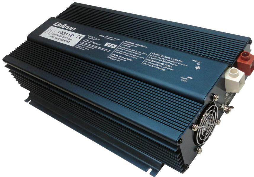
O Inversor Unitron 1000 SP 24V produz tensão senoidal pura, 127 Vca/60Hz, a partir de alimentação em 24Vcc. Dispõe de proteção eletrônica contra sobrecarga ou curto-circuito na saída, e desligamento automático por tensão baixa (LVD) ou alta (HVD) na bateria, com rearme automático.
