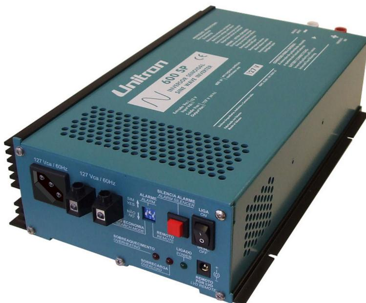
O Inversor Unitron 600 SP produz tensão senoidal pura, 220Vca / 60Hz, a partir de alimentação em 24Vcc. Dispõe de proteção eletrônica contra sobrecarga ou curto-circuito na saída, com rearme automático, e desligamento automático por baixa tensão da bateria (LVD).
