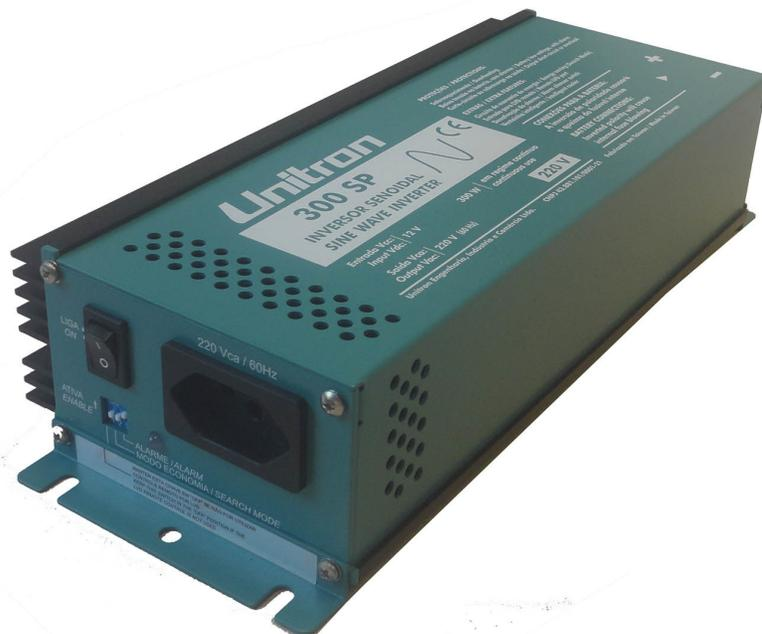
O Inversor Unitron 300SP produz tensão senoidal pura, 127Vca/60Hz, a partir de alimentação em 12Vcc. Dispõe de proteção eletrônica contra sobrecarga ou curto-circuito na saída, com rearme automático. Provê também desligamento automático por baixa e alta tensão na bateria (LVD/LVR), com rearme automático.
