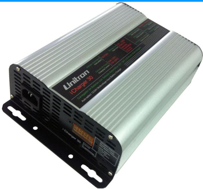
O Carregador Unitron iCharger 30 trabalha em tensões de entrada de 100 a 240 Vca, 50 a 60Hz, e detecta automaticamente a tensão da bateria, 12 ou 24 V. Apresenta alta eficiência, da ordem de 85%, e fornece 30 A em 12V ou 15 A em 24 V. Dispõe de proteções contra inversão de polaridade, sobrecarga, curto-círcito e superaquecimento.
