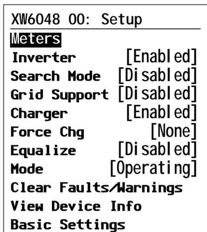
Nota: En el panel del control del sistema aparecen sólo cuatro líneas del menú Setup (Configuración) de forma simultánea. Para ver parámetros de configuración adicionales, pulse el botón de flecha hacia abajo.
