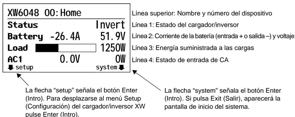
**Figura 2-6** Pantalla Home (Inicio) del cargador/inversor XW
