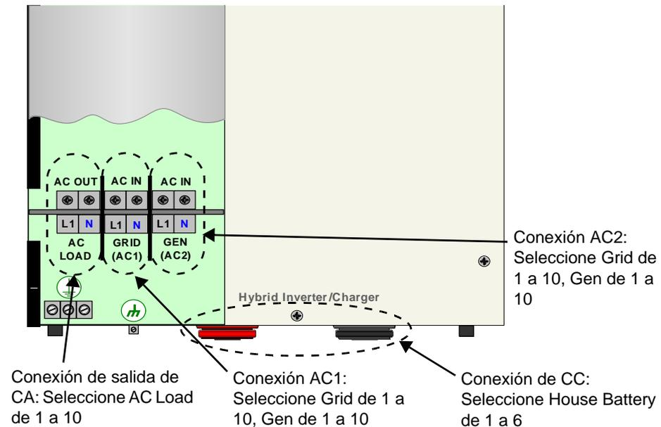
**Figura 3-8** Representación de las conexiones del cargador/inversor XW
