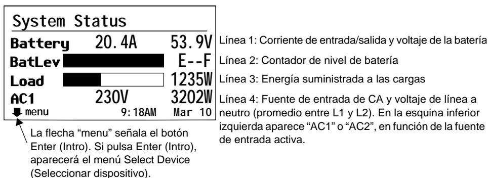
Figura 2-5 Pantalla System Status (Estado del sistema)
