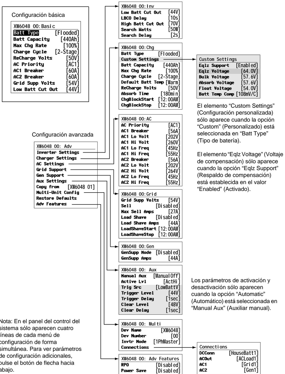
Nota: En el panel del control del sistema sólo aparecen cuatro líneas de cada menú de configuración de forma simultánea. Para ver parámetros de configuración adicionales, pulse el botón de flecha hacia abajo.
