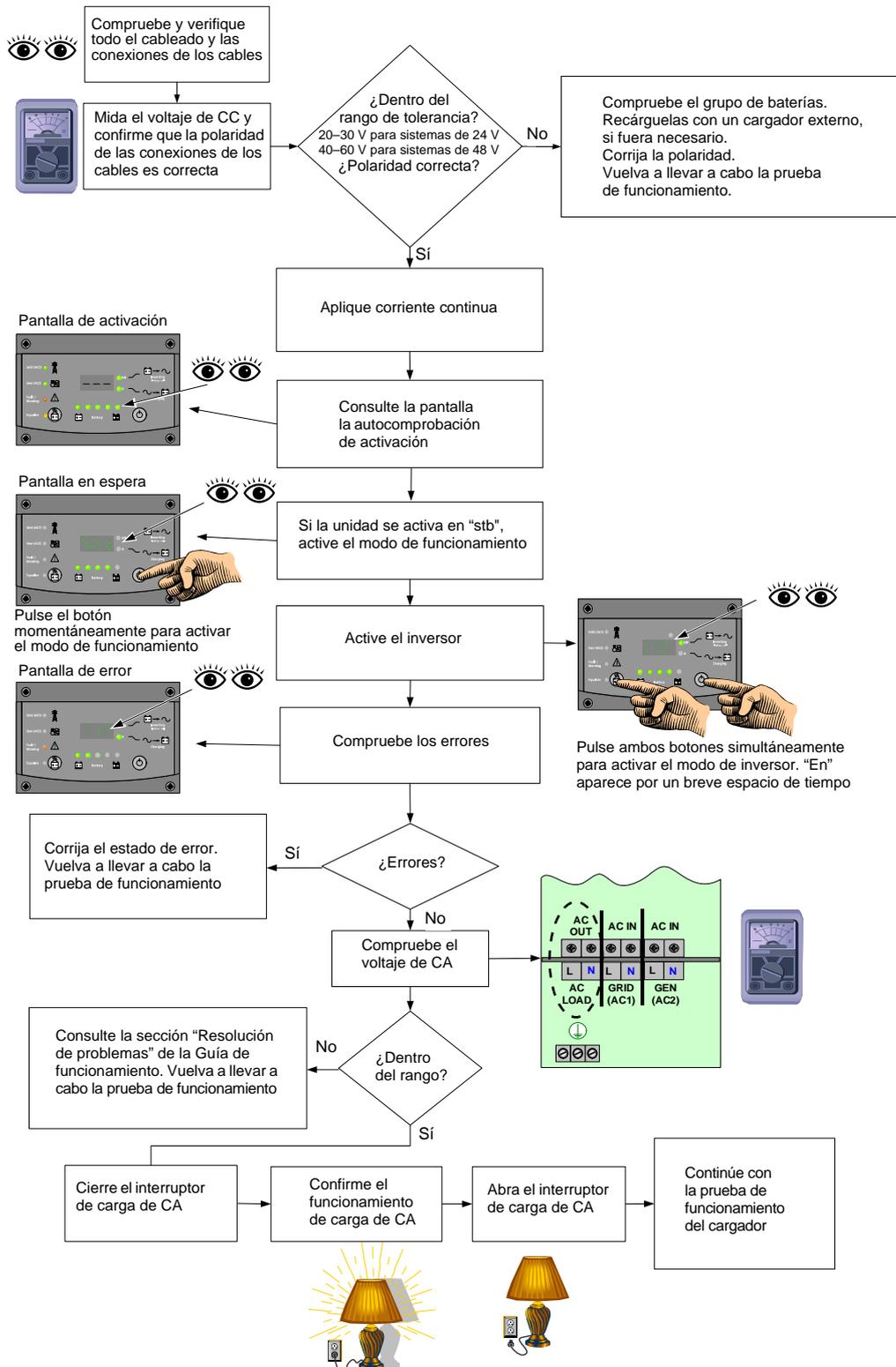
Figura 2-21 Prueba de funcionamiento para sistemas de inversores únicos
