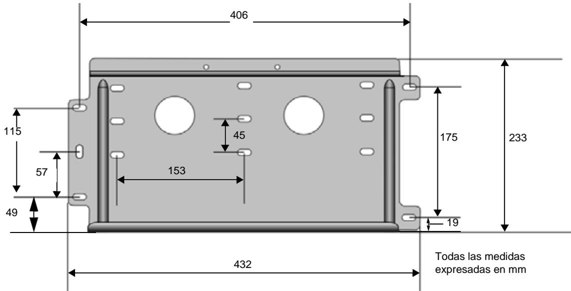
Figura 2-2 Dimensiones de la placa de montaje
