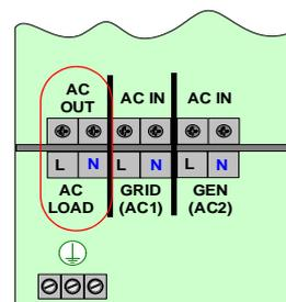
Figura 2-19 Comprobación de voltaje de CA
