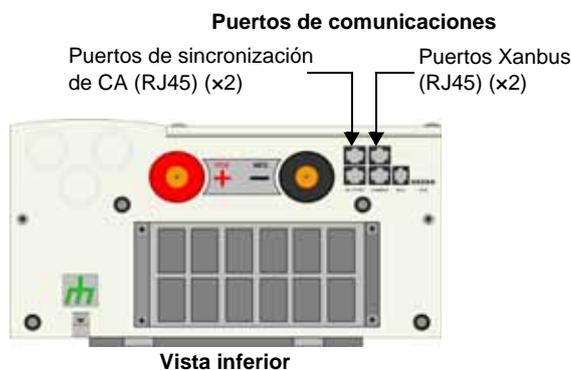
Figura 2-5 Puertos de comunicaciones del cargador/inversor XW
