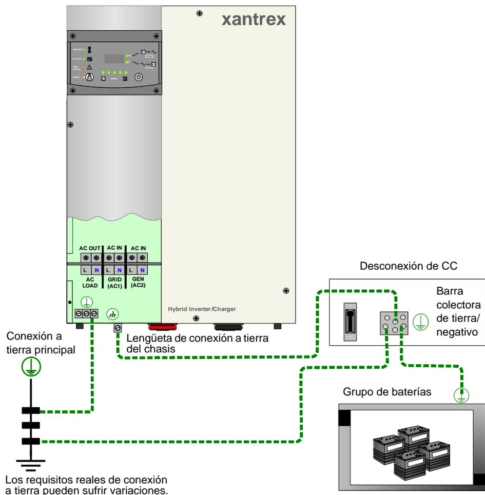
Figura 2-8 Conexión a tierra de CC con un panel de distribución de potencia
