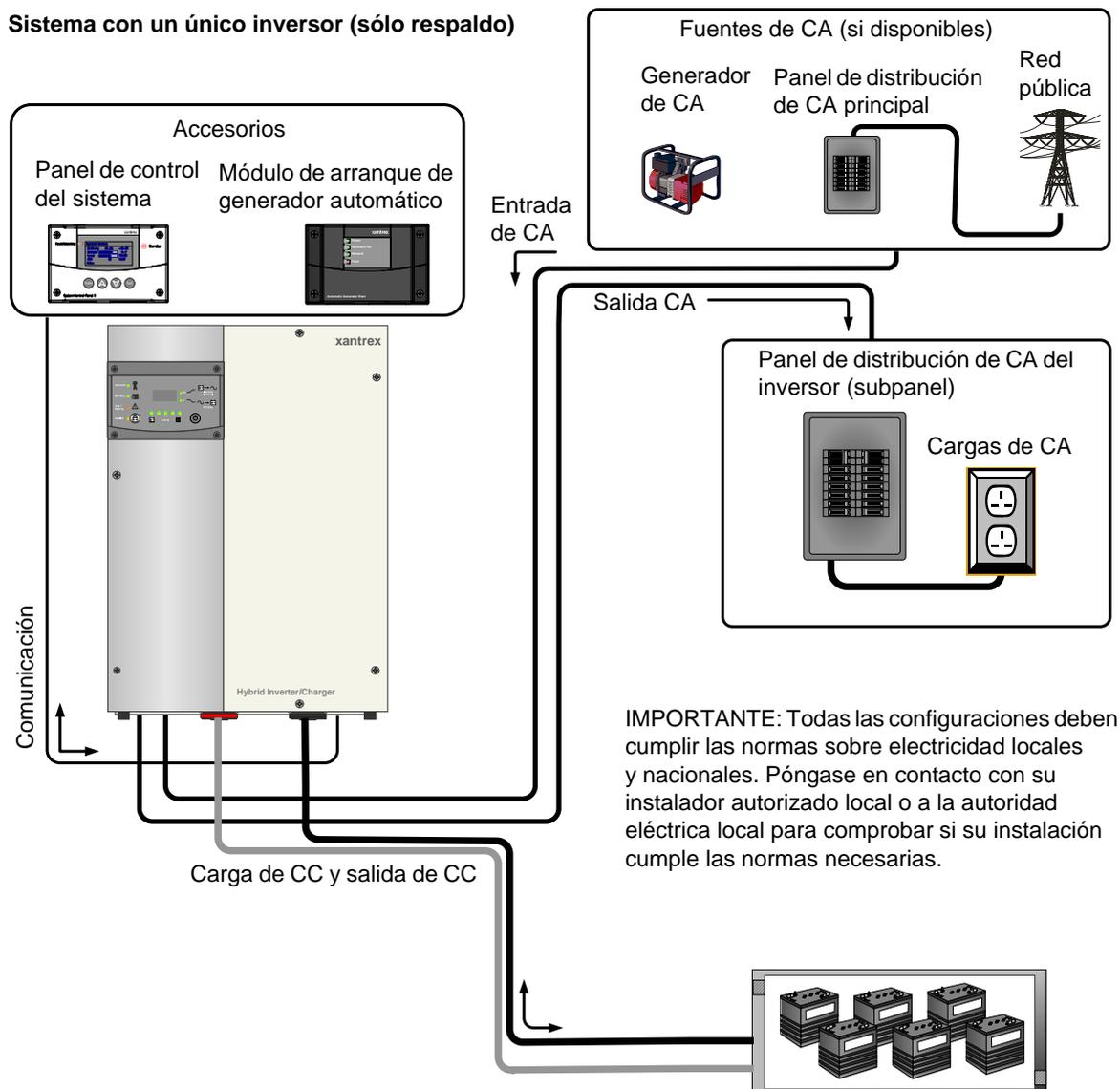
Figura 1-1 Ejemplo de instalación del sistema de alimentación eléctrica XW con respaldo únicamente
