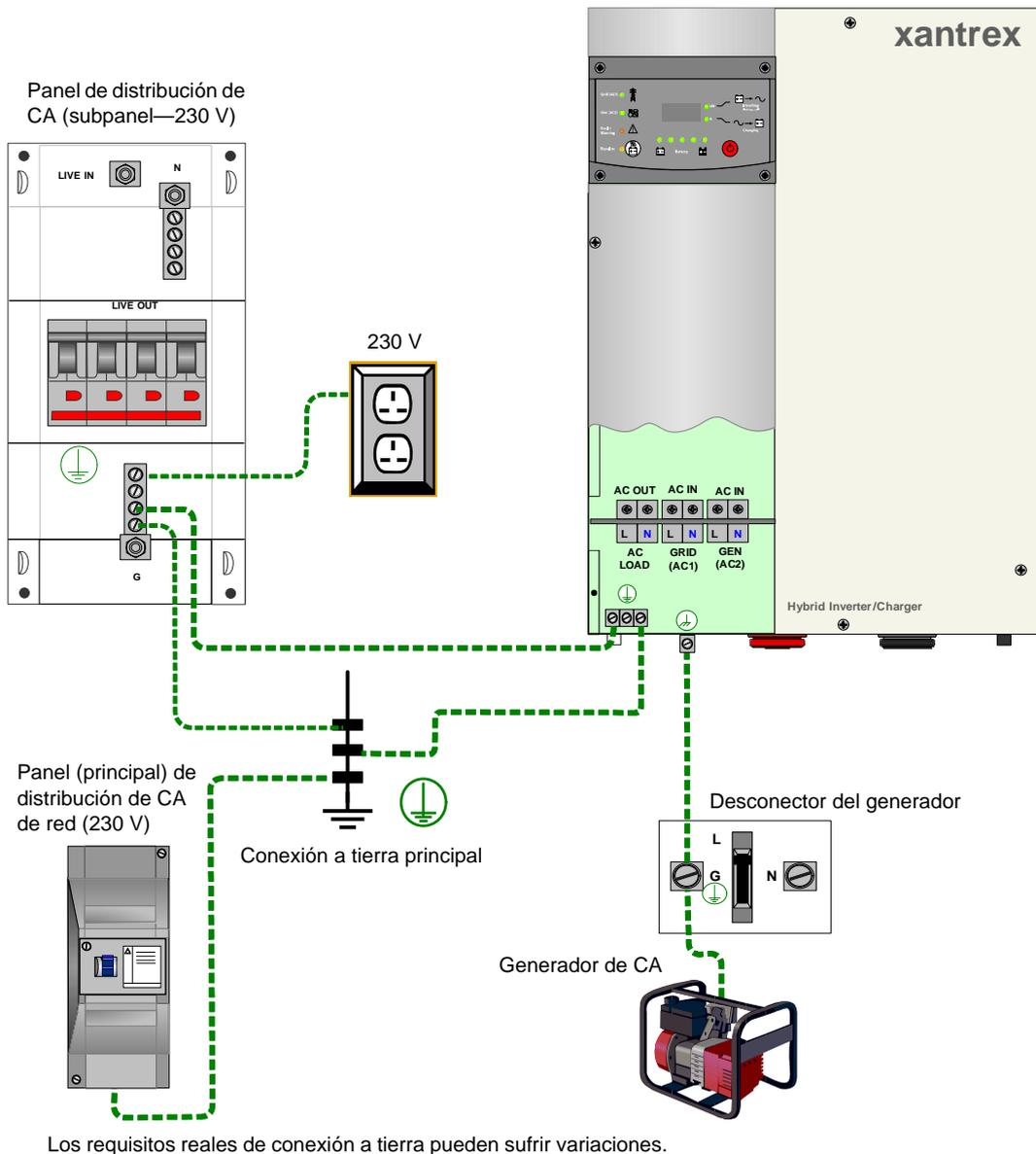
Figura 2-13 Conexión a tierra del sistema de CA
