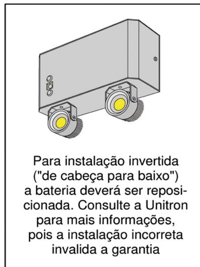
O Uni2-LED é uma central de iluminação de emergência dotada de dois projetores a LED de 5W cada, que acendem automaticamente ao faltar energia elétrica no local. Dotado de uma bateria VRLA de 6V isenta de manutenção (opcionalmente, duas baterias), provê autonomia de cerca de uma hora e meia (ou próxima a três horas, com duas baterias).
