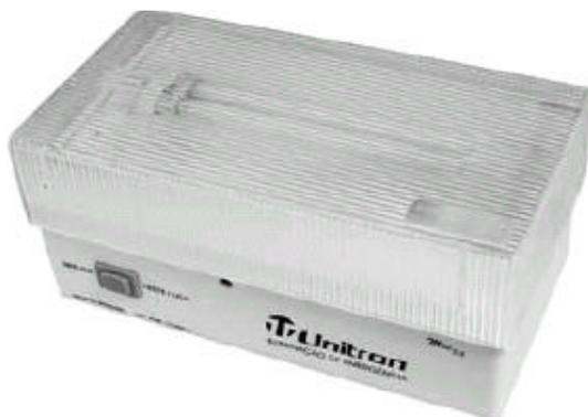
As luminárias da linha Mac destinam-se a iluminação e/ou balizamento de emergência ou normal-e-emergência. Trabalham com bateria selada (VRLA), isenta de manutenção, e lâmpadas fluorescentes compactas, de alto rendimento. São produzidas em 3 versões básicas: Mac 1 x 9 (uma lâmpada de 9W), Mac 2 x 9 (duas lâmpadas de 9W) e Mac 1 x 9 NE (duas lâmpadas de 9 W, uma para condição normal e outra para emergência).
