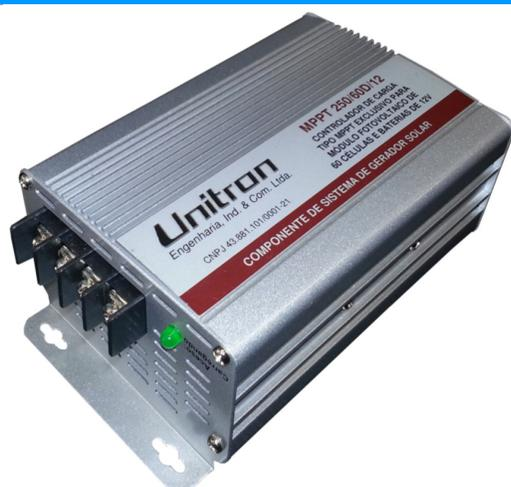
O Controlador de Carga tipo MPPT, ligado entre um módulo solar e uma bateria, funciona como um gerenciador e otimizador de carga, carga, mantendo a bateria dentro de condições ideais de trabalho, de forma a assegurar para a mesma uma longa vida útil. Este produto converte a tensão típica de um módulo de 60 células, de aproximadamente 30 V, em corrente para carga de uma bateria de 12 V, obtendo assim aproximadamente 30% a mais em eficiência, com relação aos sistemas com controladores tipo PWM.
